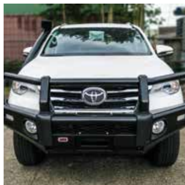
Pare-buffle renforcé, prise treuil, clignotants, feux antibrouillard
