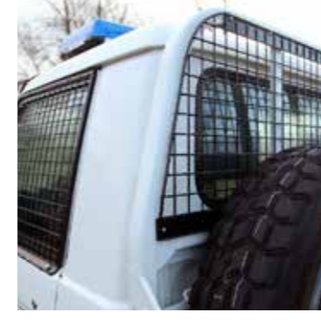
Grilles de protection métal (noir) - pare-brise et vitres
