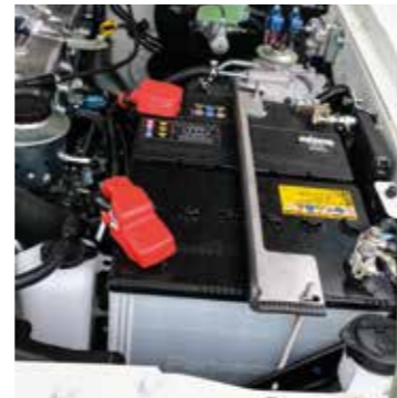
Batterie additionnelle 12V, 90 A/h
