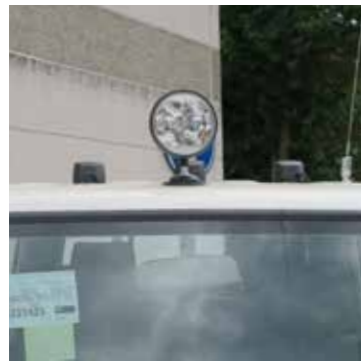
Lampe de recherche, contrôle manuel Searchlight, long range (manual control) Ref. 10TF0007
