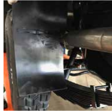
Gardes boue allongés (anti projection sable / gravier)
