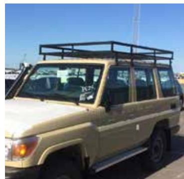
Galerie de toit - Métal renforcé Roof rack heavy duty LC76 Ref. 20TF0001
