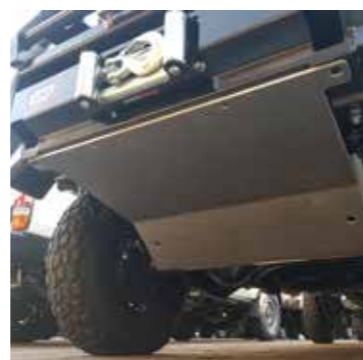
Plaque de protection avant - avec pare-buffie complet
