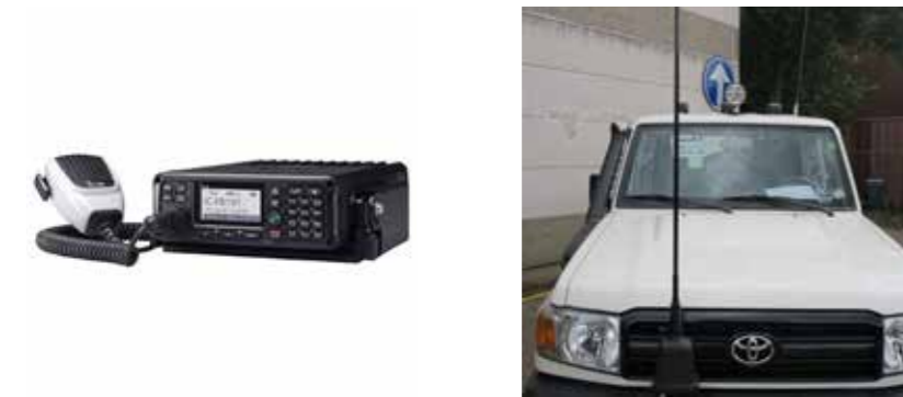
Radio HF ICOM IC-F8101 radio, avec antenne AH-760
