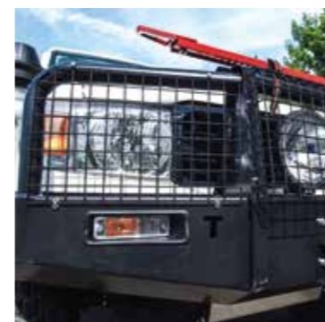
Grille de protection phares avant et calandre, intégrée au pare-buffle Meshguard for front lights and radiator - integrated with bullbar HILUX D/C, SC Ref. 20TF0090
