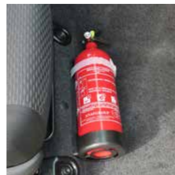
Extincteur 2 kg, installé
