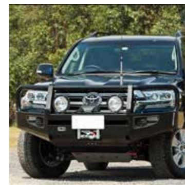
Pare-buffle renforcé, prise treuil, clignotants, feux antibrouillard
