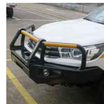
Pare-buffle renforcé, prise treuil, clignotants, feux antibrouillard
