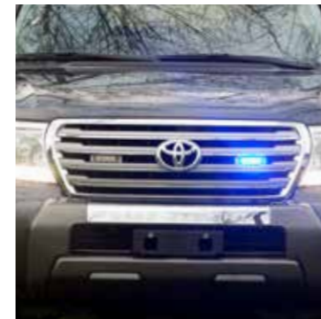
Lampes à flash dans la calandre, alternantes, bleu/bleu (x2)
