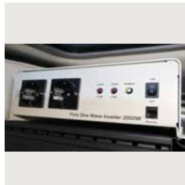
Prise électrique 230V x2 - intérieure avec convertisseur 2000W et câblage batterie
