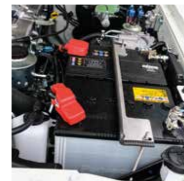
Batterie additionnelle 12V, 90 A/h
