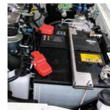
Batterie additionnelle 12V, 90 A/h Battery extra 12V, 90 A/h Ref. 10TF0055
