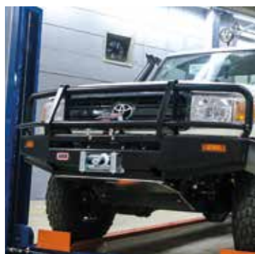
Pare-buffle renforcé, prise treuil, clignotants
