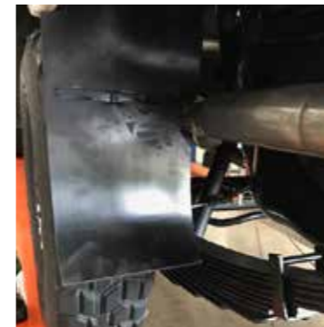
Gardes boue allongés (anti projection sable / gravier)
