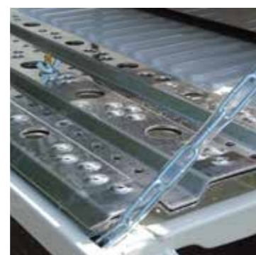
Plaques de désensablage (x2), aluminium, longueur 1,5m, fixées
