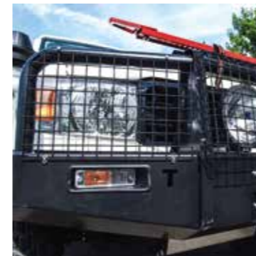
Grille de protection phares avant et calandre, intégrée au pare-buffle
