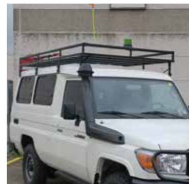
Galerie de toit - Métal renforcé Roof rack heavy duty LC78 Ref. 20TF0003
