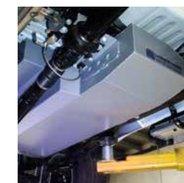
Remplacement réservoir de carburant 140 Ltr. (Diesel)
