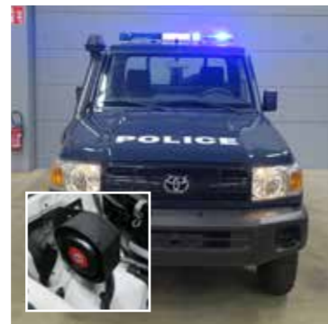
Rampe lumineuse Bleu/Bleu ou Bleu/Rouge, LED, sirène sous le capot
