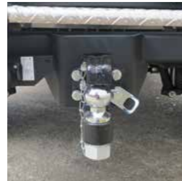
Crochet / boule d'attelage - 50mm, avec prise élec. 7 broches
