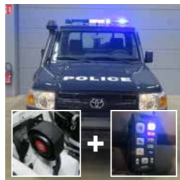
Rampe lumineuse Bleu/Bleu ou Bleu/Rouge, LED, sirène et haut-parleur sous le capot
