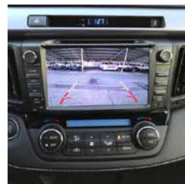
Caméra de recul connectée à l'écran central Rear view camera connected to central screen Ref. 40TF0012
