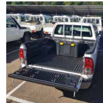
Bedliner noir renforcé (non compatible arceau Safety Devices)
