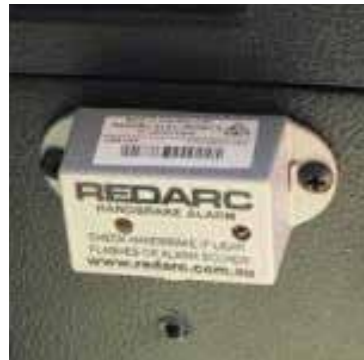
Alarme de frein à main Handbrake alarm Ref. 10TF0087
