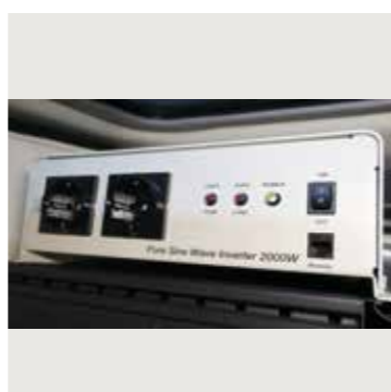
Prise électrique 230V - int. (avec convert 2000W et câblage batterie)
