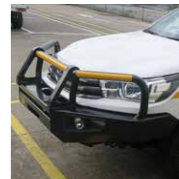
Pare-buffle renforcé, prise treuil, clignotants, feux antibrouillard
