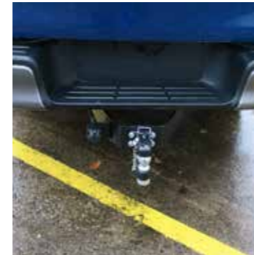
Crochet / boule d'attelage - 50mm, barre, avec prise élec. 7 broches
