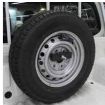
Support de roue de secours, installé (Benne/Galerie de toit)
