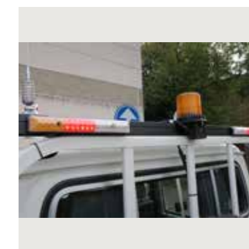
Rampe lumineuse avec mining gyro orange et alarme de recul
