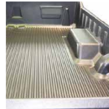
Bedliner noir renforcé (non compatible arceau Safety Device)
