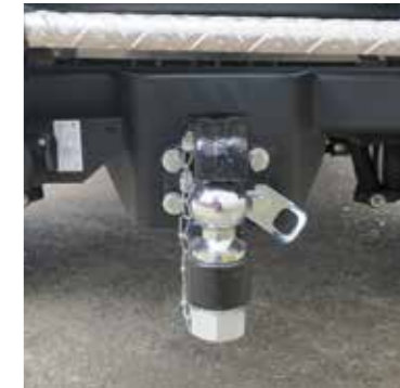
Crochet / boule d'attelage - 50mm, avec prise élec. 7 broches
