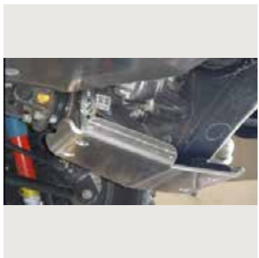
Plaque de protection - Différentiel arrière
